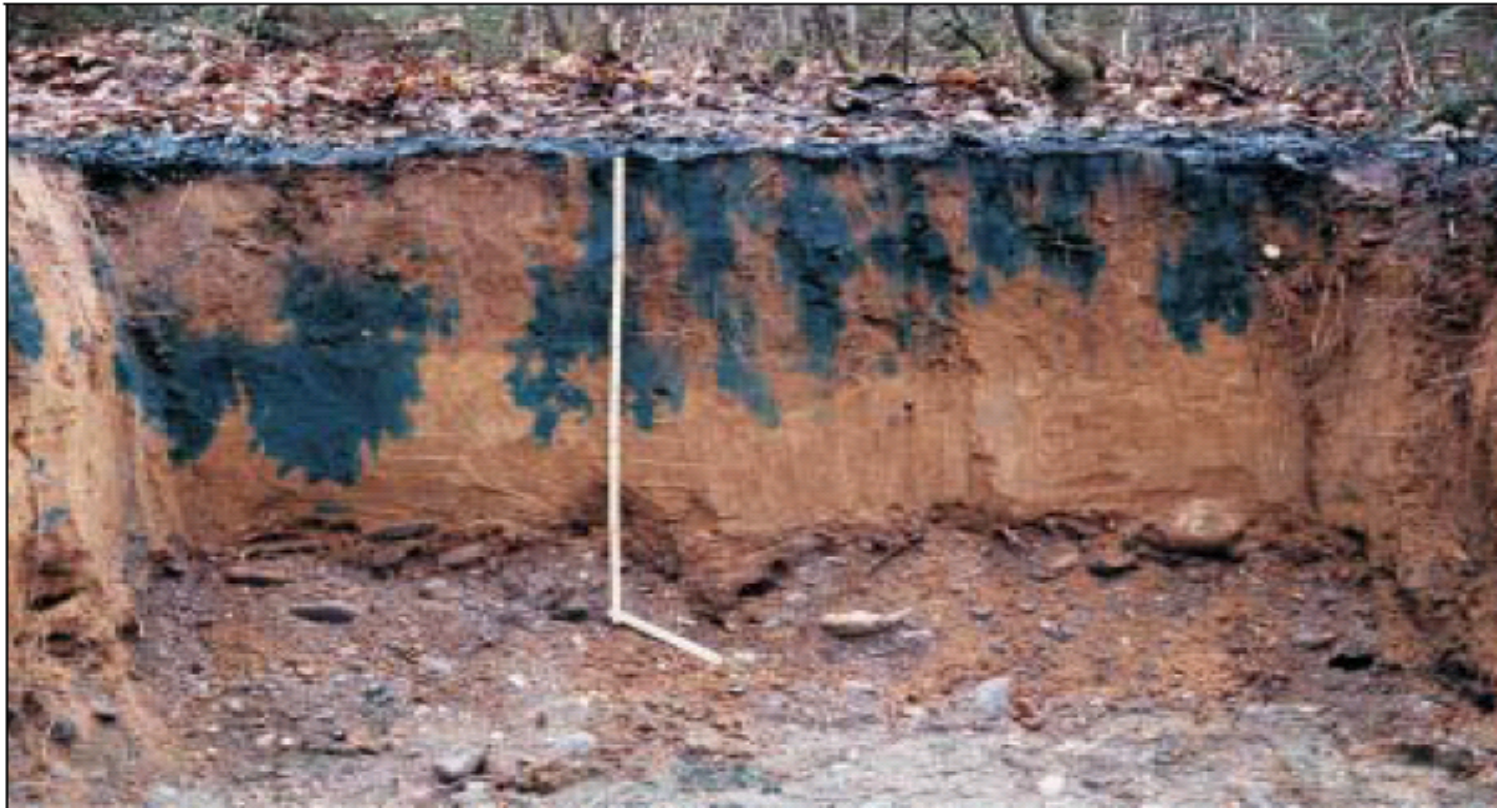
Abb. 6: Farbtracerverteilung in einer sandigen Braunerde über Schotter nach Infiltration von 36 mm in 7 h [Gimmi et al., 1997]. Links war der Anfangswassergehalt im Oberboden tiefer als rechts.
